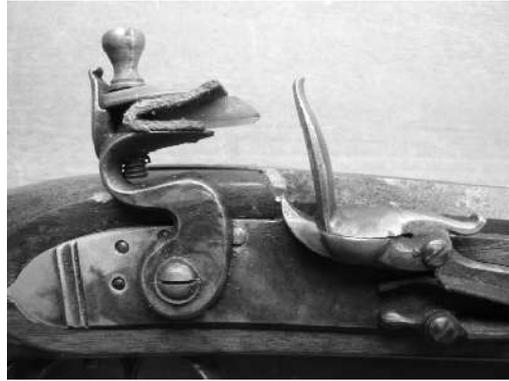
写真5 ハンマーが上がった状態。強いバネが内部で圧縮されている。
