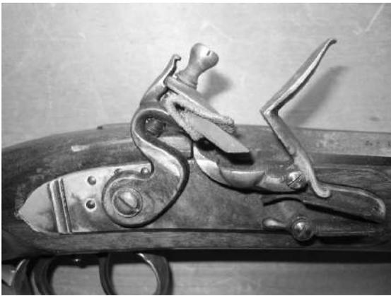
写真6 引き金を引いてハンマーが落ちた状態。この時に火花が出て、火皿の火薬に着火する。
