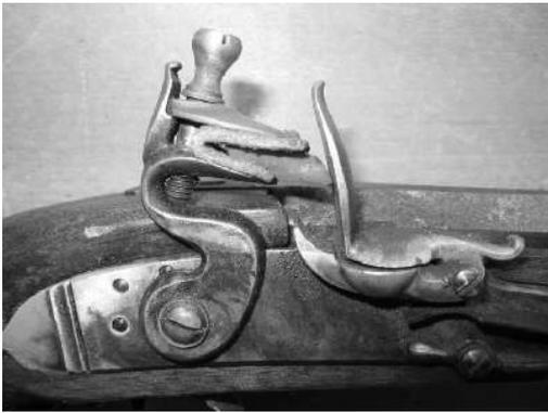
写真4 ハンマーはハーフロックの状態、火蓋（火打鉄を兼ねる）は閉まっている。
