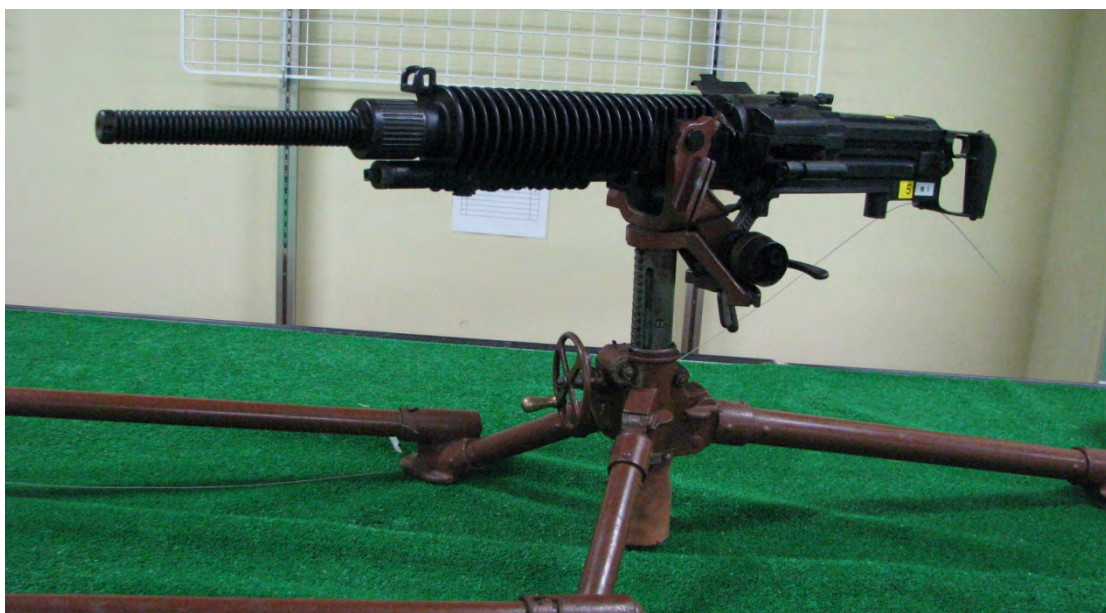
⑥（三年式地上用機関銃、三脚架に載せたまま運搬できた）
