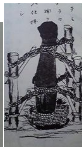
⑩⑪江戸も後期中島流砲術架台の図、駐退理論も理解していない例だろう
